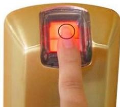
Ne pas mettre le doigt au dessous du capteur
