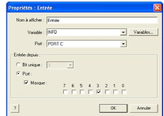
Cependant, on utilisera la fonction Masque plutôt quand on doit tester plusieurs bits ou lorsque certains bits d'un port sont des entrées et d'autres des sorties.
